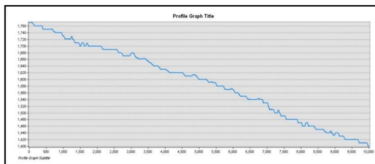
شکل ۲. نمایی از پروفیل طولی رودخانه به منظور تعیین شیب کف بستر
