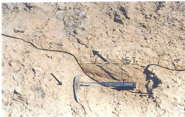
شکل ۱۰- ج) گسل جوان با موقعیت N 60 W / 80 / NE و زاویه ریک 45 NW (Rake) در بین رسوبات نیمه سخت شده واریزه و مخروط افکنه - ST : امتداد سطح گسل : جهت حرکت
