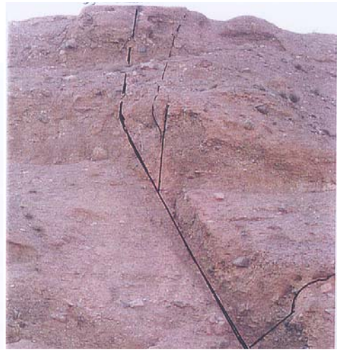
شکل ۱۰- الف) شکستگی با موقعیت E-W / 60/N در رسوبات نیمه سخت شده مخروط افکنه سرباغ، جورشدگی ضعیف رسوبات
