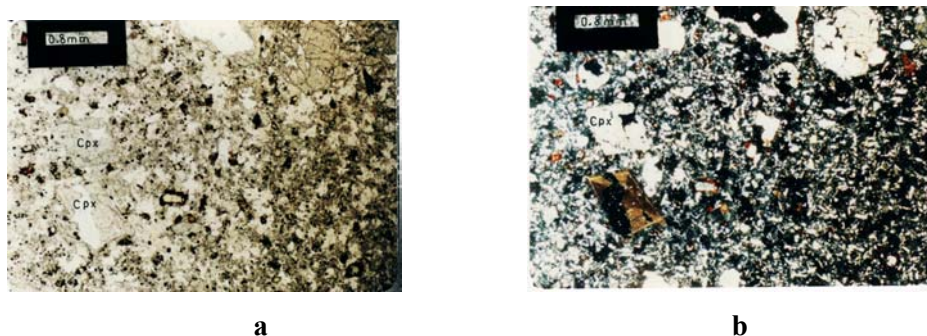
شکل ۱۲- بازالت غنی از کلینوپیروکسن (Cpx)، (بزرگ‌نمایی ۱۲x) ppl (a) xpl (b)
