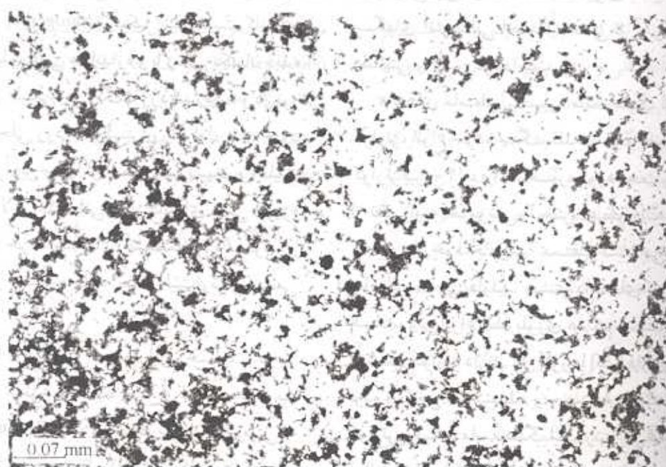
شکل ۶- رخساره سیلتستونی در زیر میکروسکوپ (نورپلاریزه).
