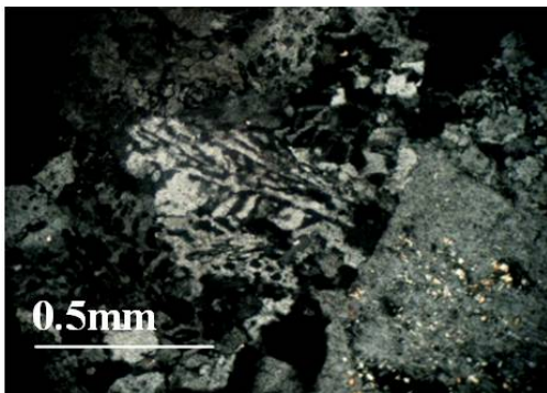
شکل ۶. بافت میرمکیت زانده‌ای و منفرد
