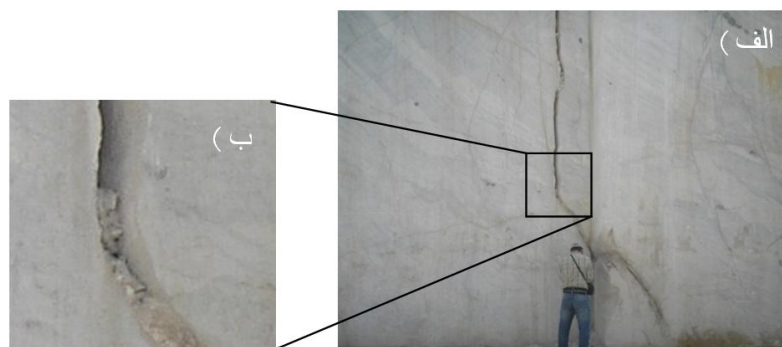
شکل ۶. الف) تصویر درز J7 که با درز پایینی خود ساختار قلاب‌شدگی را نشان می‌دهد. این ساختار داخل محدوده مستطیلی و با پیکان قرمز رنگ مشخص شده است (دید به سمت جنوب باختر) ب) نمای نزدیک از ساختار قلاب‌شدگی
