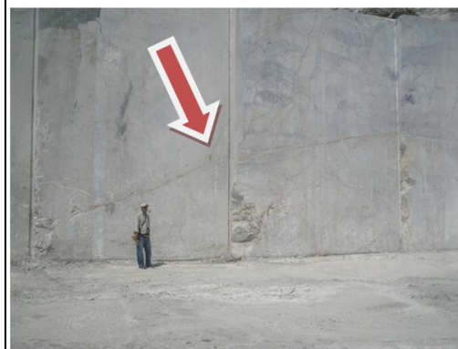
شکل ۱۴. نمایی از درز J5 که با پیکان قرمز مشخص شده است شکل ۱۵. نمایش صفحه درز J5 در محیط نرم‌افزار DIPS5.1 (دید به سمت جنوب باختر)
