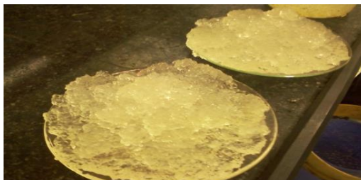
شکل ۳. تصاویر هیدروژل‌های متورم ساخته شده با فراصوت (راست) و نمونه خشک پودری (چپ)
