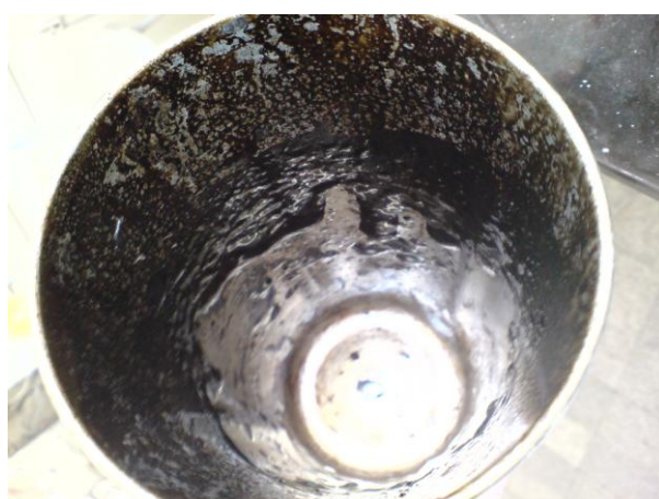
شکل ۸. عکس تانکر شبیه‌سازی شده (لیوان آهنی مخروطی) آغشته به نفت پس از اضافه شدن محلول رامنولیپید تولید شده با غلظت CMC. تمیز شدن کف و دیواره جانبی ظرف کاملاً قابل مشاهده است
