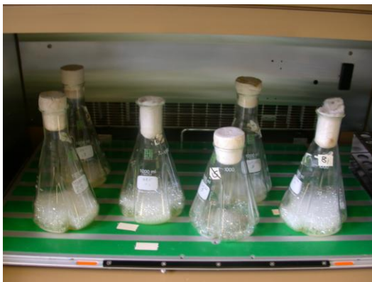
شکل ۴. تولید رامنولیپید درون ارلن‌های ۱۰۰۰ میلی‌لیتری در یک شیکرانکوباتور در 37^{\circ}\text{C} و 120\text{ rpm} در حین تولید رامنولیپید کف تولید می‌شود.
