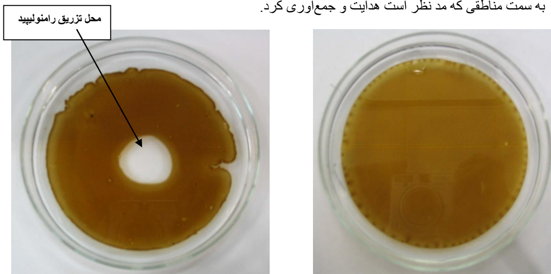
شکل ۵. ایجاد لایه نفتی بر روی سطح آب (شکل سمت راست) و تشکیل ناحیه شفاف در سطح لایه نفتی پس از افزودن رامنولیبید تولید شده (شکل سمت چپ)
