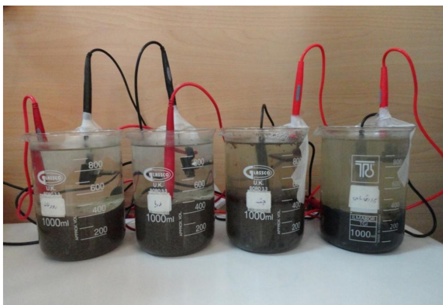
شکل ۱. پیل‌های سوختی رسوبی راه اندازی شده با ۴ اکوسیستم مختلف در آزمایشگاه
