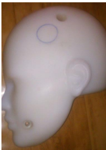
شکل ۲. مدل ساخته شده سر توسط دستگاه CNC
