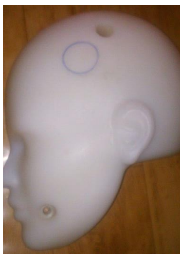
شکل ۲. مدل ساخته شده سر توسط دستگاه CNC
