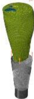
شکل ۹. شرایط مرزی و بارگذاری اعمال شده به مدل اجزاء محدود ساق پا-منسوج فشاری.
