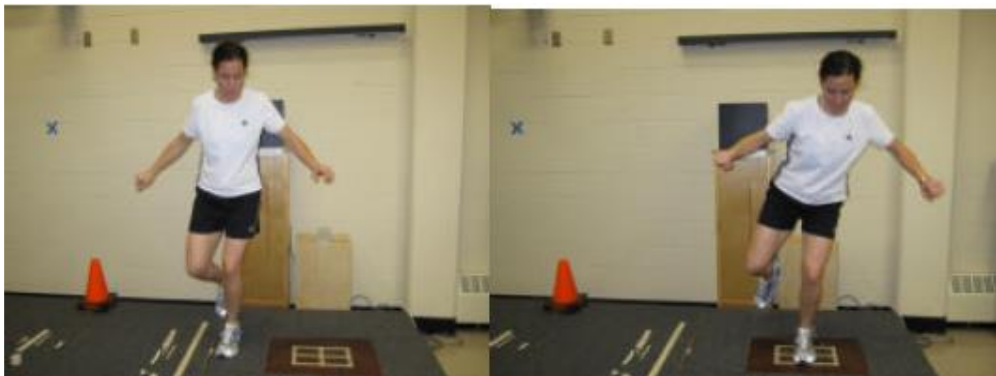
شکل ۲. نحوه انجام پروتکل جهش جانبی روی دستگاه توزیع فشار کف‌پایی
