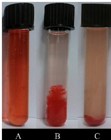
شکل ۴- A. شاهد کنگورد ۶۰۰ میلی‌گرم بر لیتر. B. زیست توده تر در غلظت ۶۰۰ میلی‌گرم بر لیتر محلول رنگ. C. زیست توده خشک در غلظت ۶۰۰ میلی‌گرم بر لیتر محلول رنگ بعد از گذشت ۳ ساعت از زمان تلقیح.
